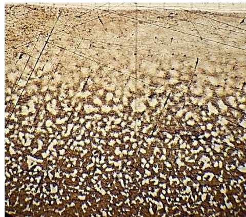
Рис. 8 – Структура упрочненной лазером зоны, \times 200 . Режим лазерной обработки: V_{об} = 0,3 м/мин; P = 500 Вт
