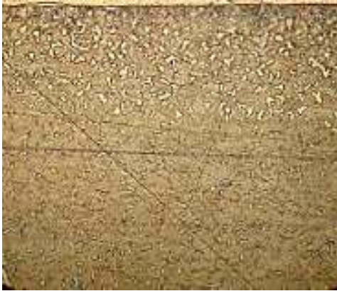
Рис. 10 – Структура упрочненной лазером зоны, \times 200 . Режим лазерной обработки: V_{об} = 0,2 м/мин; P = 300 Вт
