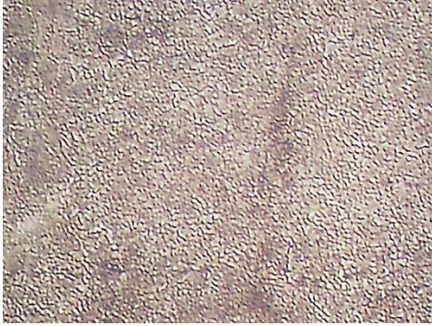
Рис. 5 – Структура стали 40 после улучшения, \times 200
