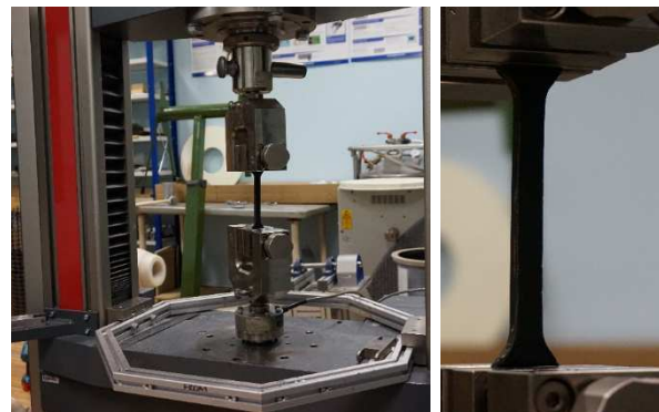
Рис. 2 – Фіксація зразків для випробувань в установці
