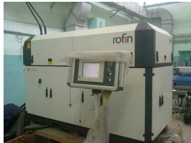
Рис. 2 – Общий вид Nd:YAG – лазера "DY044" производства фирмы "ROFIN-SINAR"
