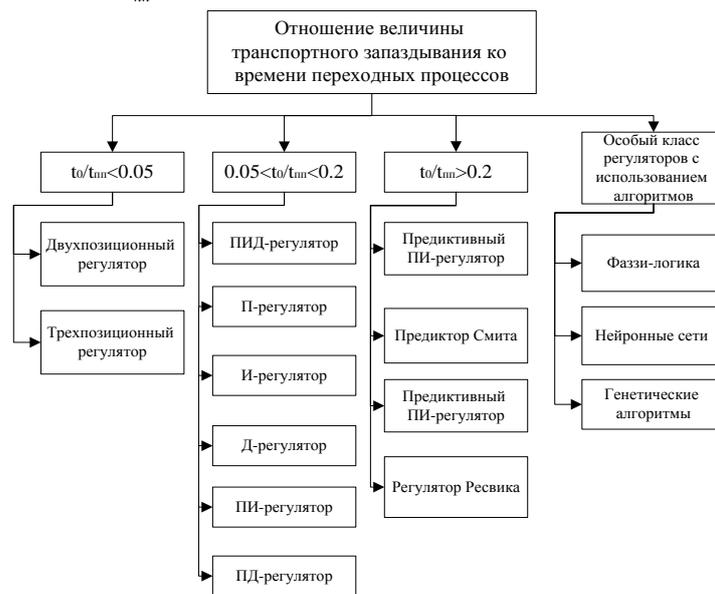
Рис. 2 – Выбор регулятора в зависимости от отношения времени транспортного запаздывания ко времени переходных процессов
