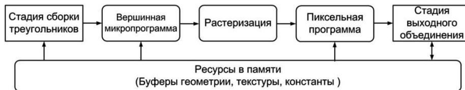
Рис.1 – Схема графического конвейера
