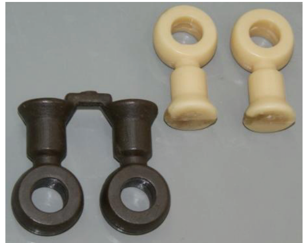
Рисунок 2 – Готовые вставки с полученными моделями штуцеров из модельной массы, запрессованными по серийной технологии
