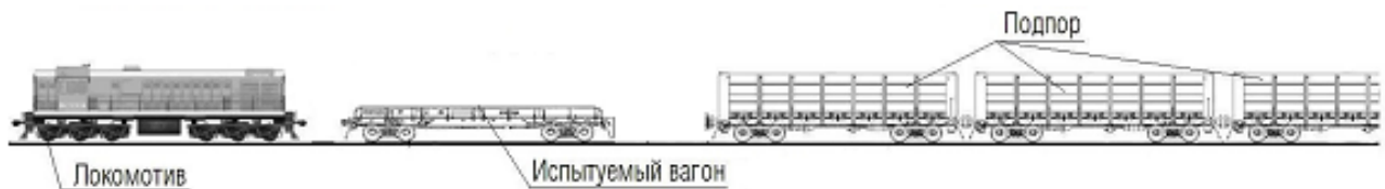
Рис. 14 – Схема расположения вагонов при испытаниях на соударение (соударения порожним вагоном в подпор, выполняются без тензометрирования)
