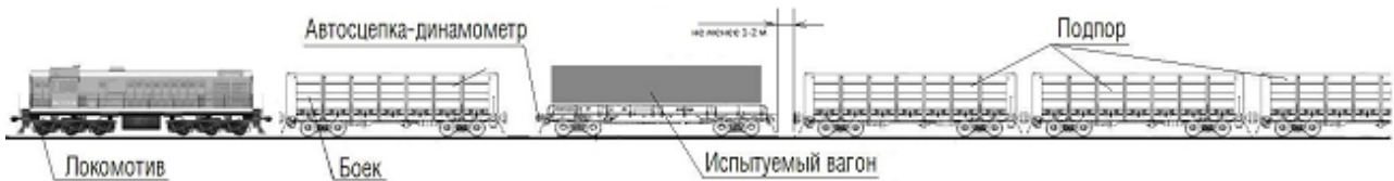
Рис. 13 – Схема расположения вагонов при испытаниях на соударение (свободностоящий вагон)
