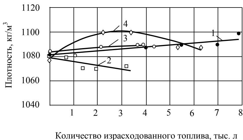
Рисунок 2 – Изменение плотности антифриза от количества израсходованного топлива:
