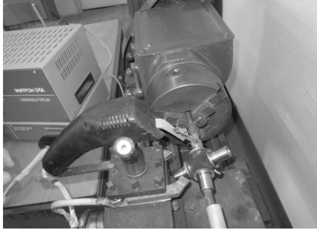
Рисунок 2 – Процес нанесення покриття електроіскровим методом на шип хрестовини карданного валу.
