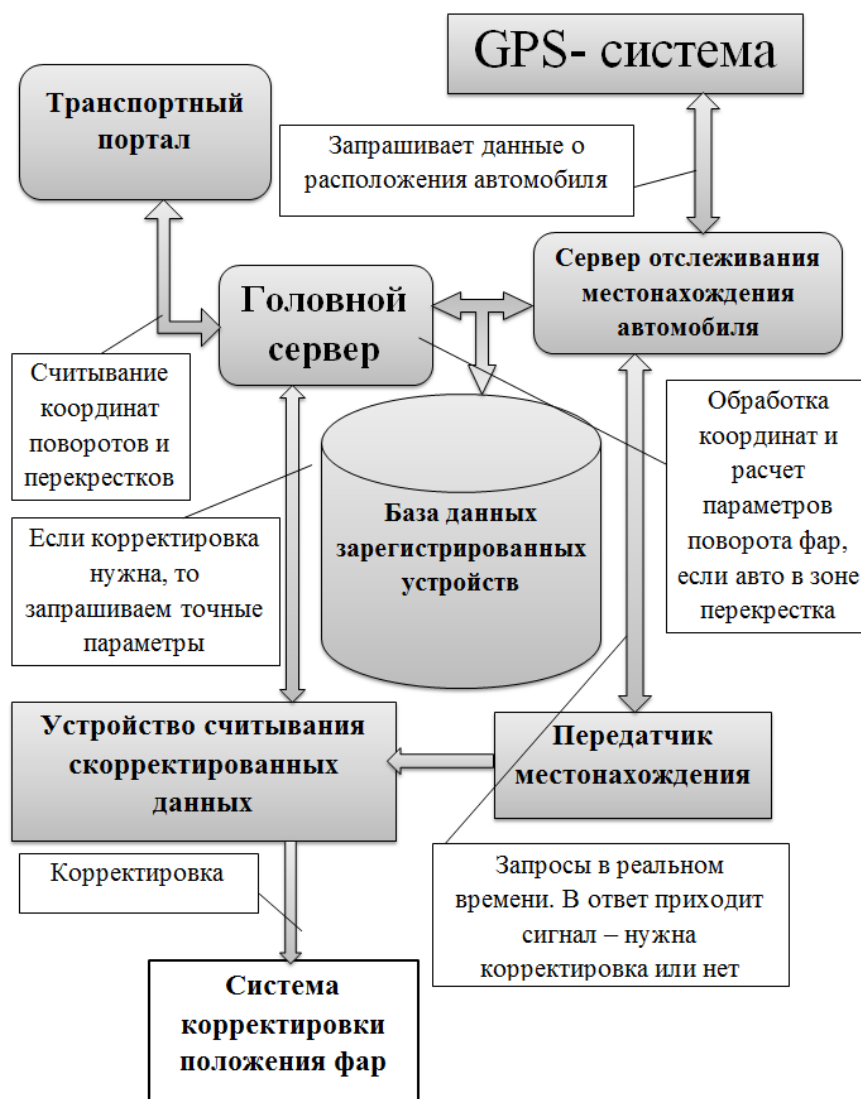
Рисунок 1 – Архитектура адаптивной системы переднего освещения
