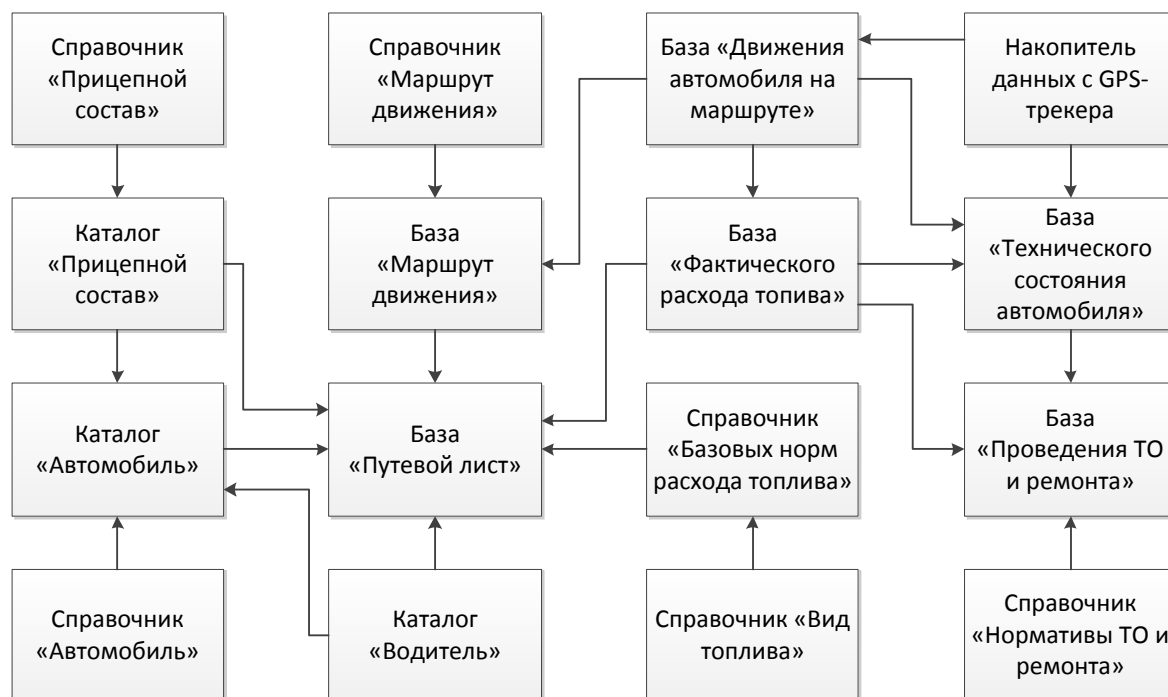
Рисунок 3 – Структура базы данных по нормированию расхода топлива в системе виртуального предприятия
