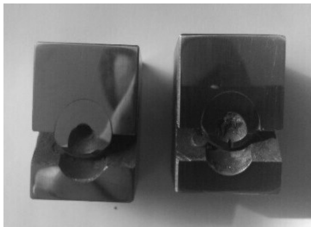
Рисунок 3 – Зразкотримач для виготовлення шліфа.
