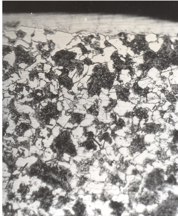
Рисунок 1 – Микроструктура оксикарбонітрированого слоя стали 45 штока амортизатора.
