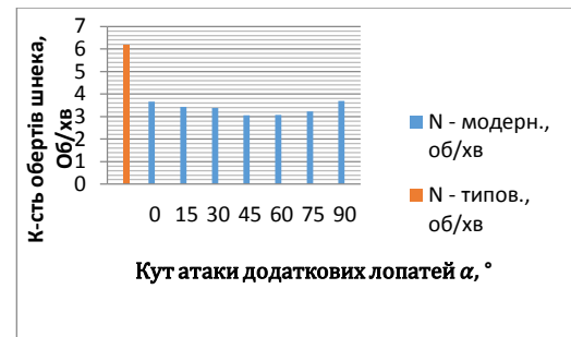
Рис. 5 – Гістограма розподілення критичних частот обертання шнеків модернізованої та класичної конструкції
