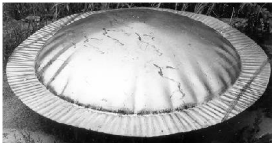
Рис. 2 – Первый этап формообразования особо тонкостенного днища
