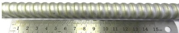
Рис. 5 – Фотографія гвинтоподібної труби, яка отримана при профілюванні обкатною головкою з планетарним обертанням роликів
