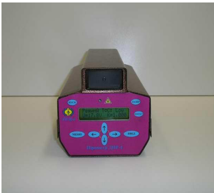
Рис. 4 – Цифровий індикатор пірометра спектрального відношення ДПР-1
