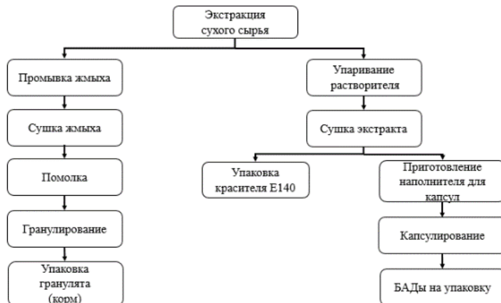
Рис. 7 – Структурная схема производства хлорофилла и добавки к корму
