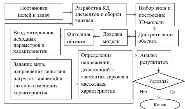
Рис. 9. – Блок-схема алгоритма исследования НДС каркаса кабины МКЭ
