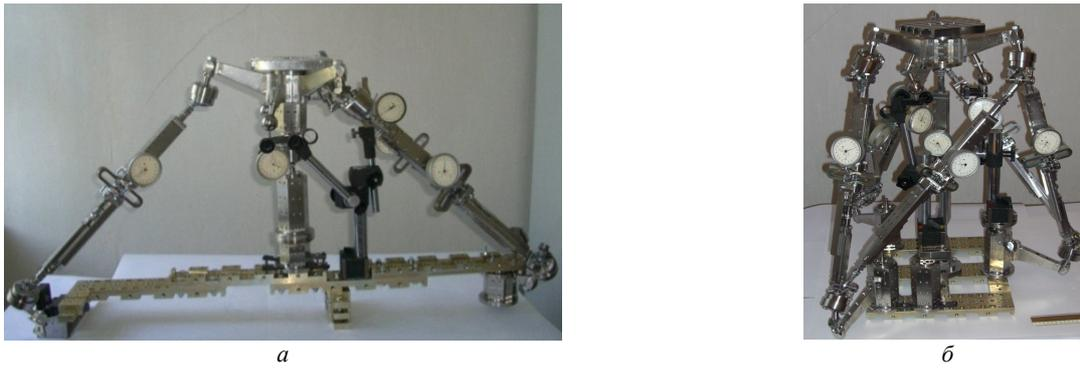
Рис. 6 – Макетні зразки просторових систем приводів, оснащені контрольно-вимірювальною апаратурою: а – механізм-трипод; б – механізм-гексапод.
