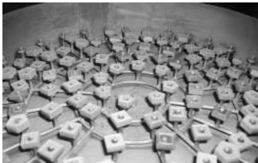
Рис. 1 – Установка для реализации технологического процесса осаждения качественных вакуумно-дуговых покрытий на твердосплавный режущий инструмент при обработке больших партий: а – схема; б – подложка с оснасткой для размещения режущих пластин
