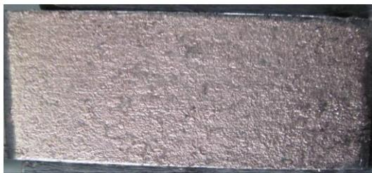
Рис. 2 – Образец стали 20 после ЭЭЛ медью
