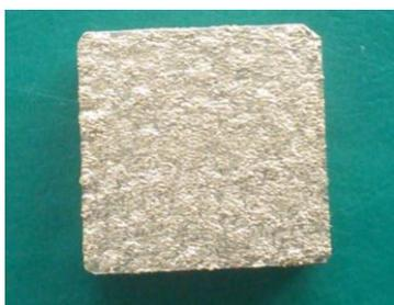
Рис. 6 – Образец стали 20 после ЭЭЛ оловянной бронзой
