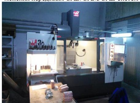
Рис. 5 – Обрабатывающем центре HAAS VF-3
