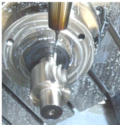
Рисунок 7 – Черновое фрезерование арочных зубьев
