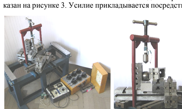
Рисунок 3 – Общий вид экспериментальной установки для исследования контактного взаимодействия
