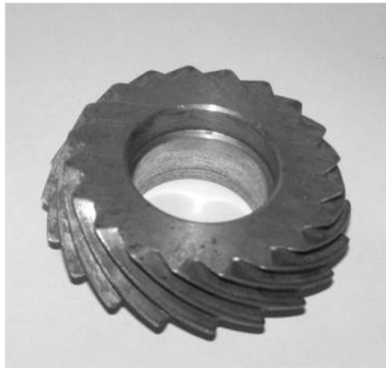
Рисунок 4 – Квазиглобoidное колесо с z_1=20 ; m=1,5 ; \beta=60^\circ
