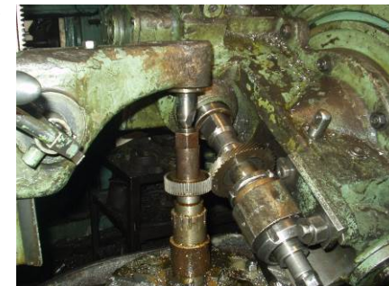
Рисунок 3 – Изготовление квазиглобoidного колеса
