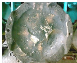
Рисунок 11 – Серійний поршень дизеля K6S310DK відпрацював 46512 мотогодин
