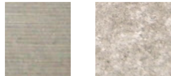
Рисунок 9 – Циліндрична поверхня поршня з АЛ25 до і після корундування
