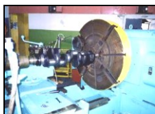
Рисунок 5 – Дискретно зміцнений колінчастий вал двигуна КамАЗ для встановлення на шасі установки "Град"
