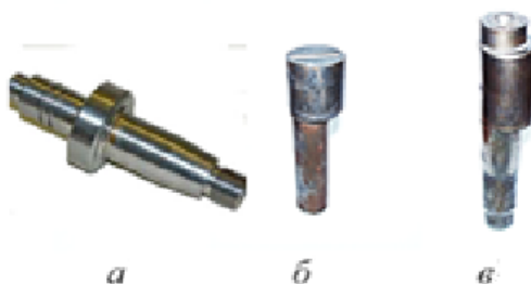
Рис. 1 – Детали типа: а – ступенчатый и б, в – эксцентриковый валы
