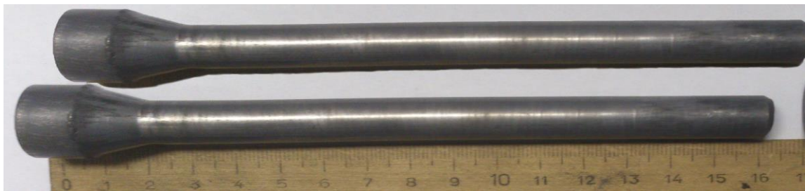
Рис. 6 – Ствольные заготовки, полученные путём гидроэкструзии на гладкой оправке
