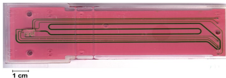
Рис. 3 – Фотографія мікрофлюїдного картриджу, що інтегровано у прилад Biacore 3000
