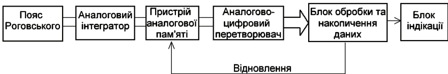
Рисунок 1 – Блок-схема системи вимірювання параметрів імпульсів струму
