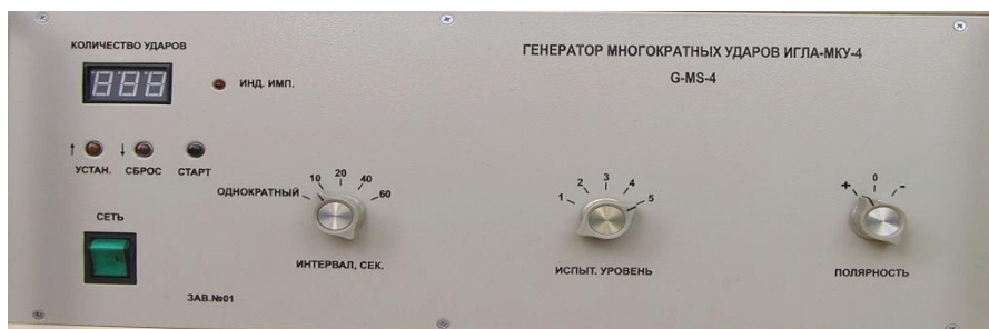
Рисунок 3 – Передняя панель генератора ИГЛА-МКУ-4
