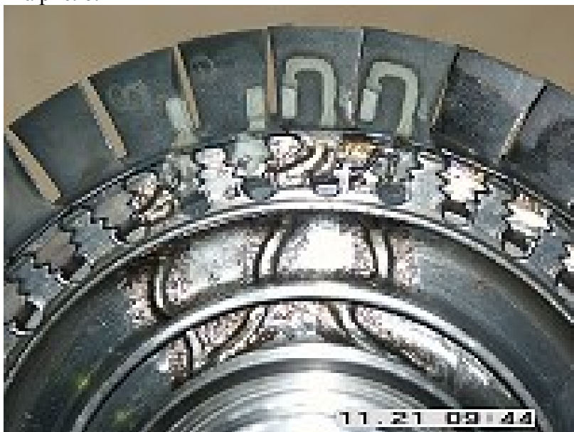
Рис. 6 – Диск турбины турбо-компрессора с закрепленными ВПТ
