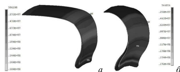
Рис. 19 – Розподіл еквівалентних напружень в каркасі (а –автомобільної шини, б–велосипедної шини)
