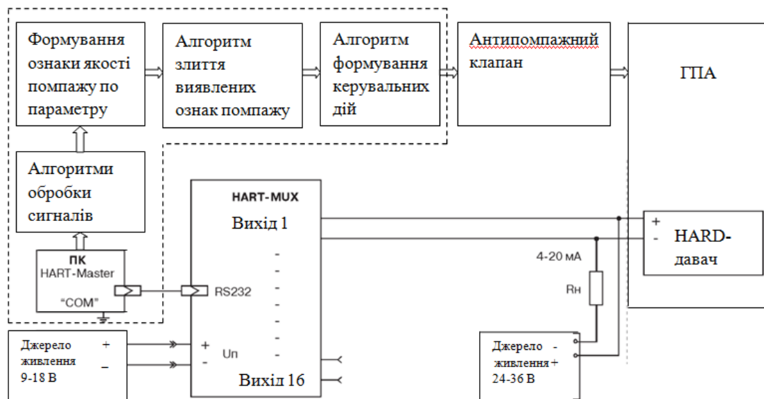
Рис. 3 – Структурна схема системи антипомпажного захисту ГПА
