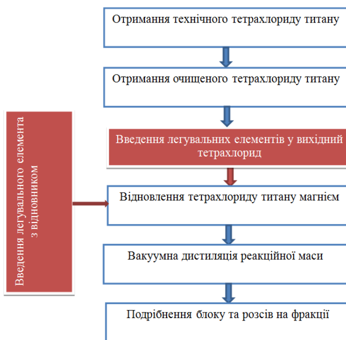
Рис. 3 – Схема вдосконаленої технології комплексного легування титану
