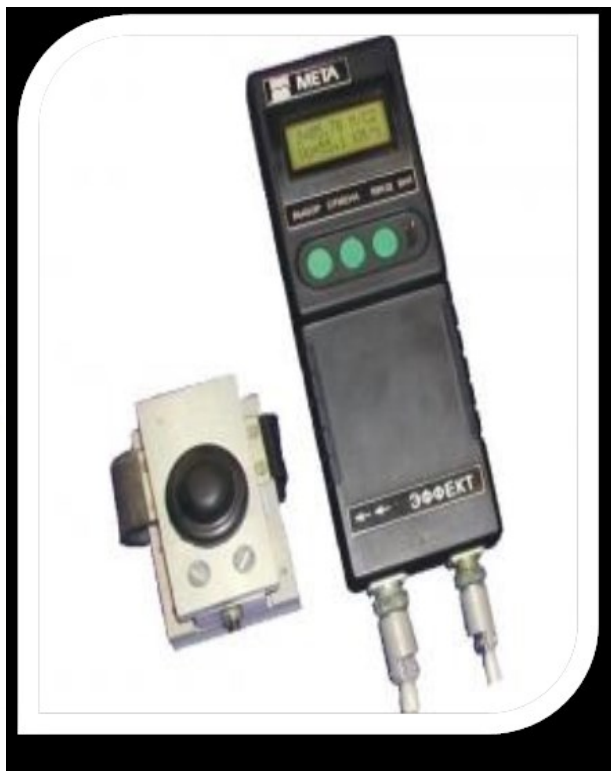
Рисунок 3 - Прилад для оцінки гальмівної ефективності транспортних засобів «Ефект»
