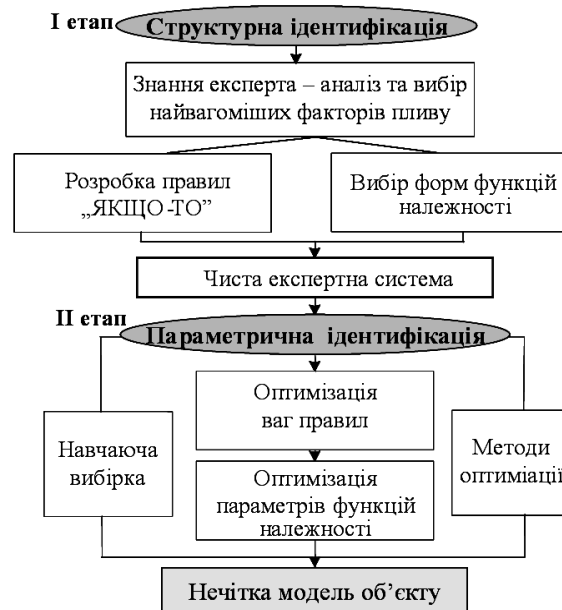
Рисунок 3 - Структура моделі визначення дальності видимості та етапи її налаштування
