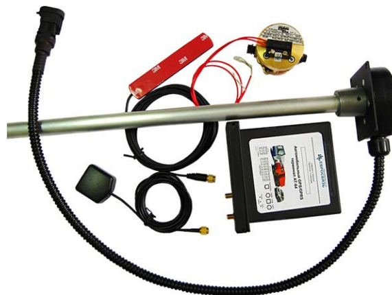
Рисунок 6 – Система GPS мониторинга расхода топлива
