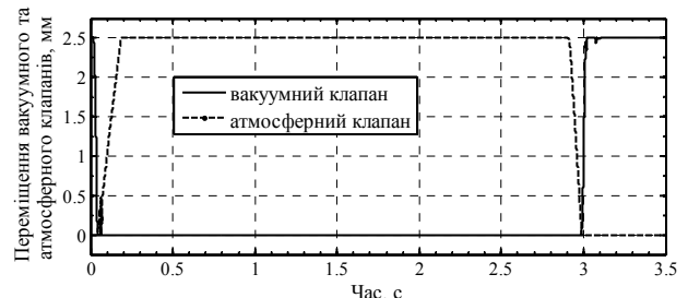
Рисунок 8 – Графік переміщення клапанів розподільвача
