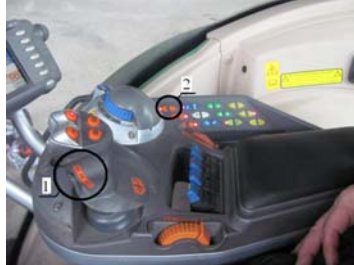
Рисунок 2 – Багатофункціональний пульт керування на консолі підлокітника: 1 – кнопка обирання ступенів прискорення на джойстику; 2 – кнопка обирання діапазонів
