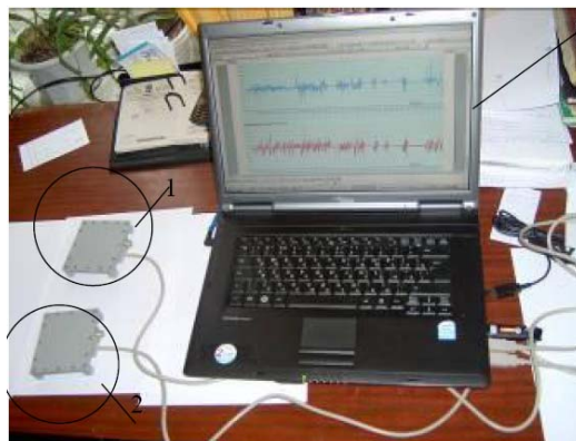
Рисунок 4 – Мобільний вимірювальний комплекс, розроблений кафедрою технології машинобудування і ремонту машин ХНАДУ: 1, 2 – акселерометри; 3 – ноутбук
