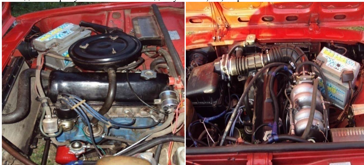
стендові випробування бензинового двигуна 4C7,6/6,6 з різними системами живлення
