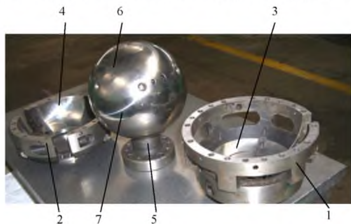
Рис. 3 – Основні деталі виготовленого опорного вузла та ділянки точних сферичних поверхонь деталей
