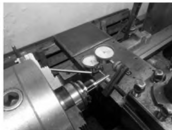
Рис. 11 – Измерения радиальной жесткости j_r оправки d=12 мм
