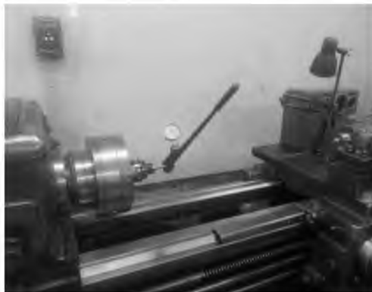
Рис. 3 – Измерение момента прокручивания M_{pr} оправки d=12 мм
