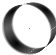
Рисунок 16 – Вариант: Круглый вал, квадратная втулка. Контактные давления
