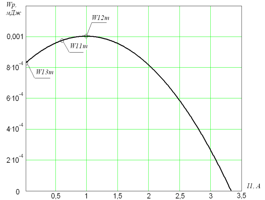
Рис. 2 - Зависимость энергии в разряде W_p от тока обрыва дуги I_1 с указанием различных вариантов его определения
