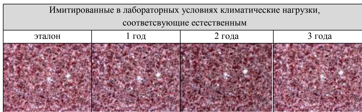
Рис. 6 – Фрагмент поверхности пробы красного песчаника с анти-граффити-покрытием А фирмы SCHEIDEL
