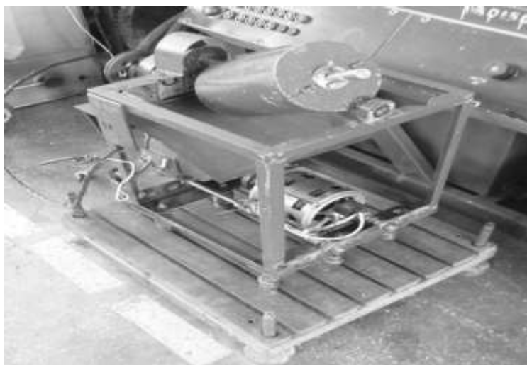
Рис. 1 – Загальний вигляд експериментальної установки для вібраційного подрібнення металічних порошків
