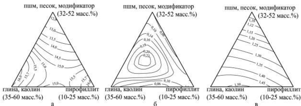
Рис. 1 – Зависимости «состав – свойство» для масс электротехнического фарфора: а – усадка, %; б – водопоглощение, %; в – интенсивность рефлексов муллита по данным РФА.
