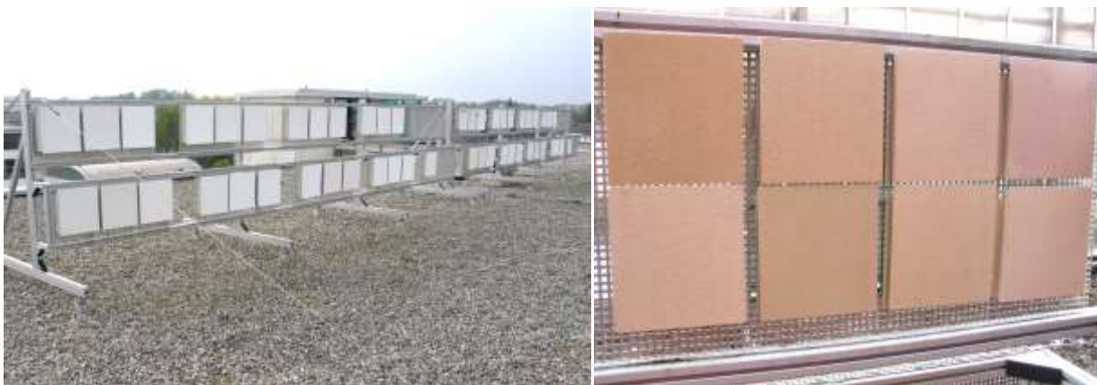
Рис. 2. – Проверка биоустойчивости образцов материалов на полевом стенде
