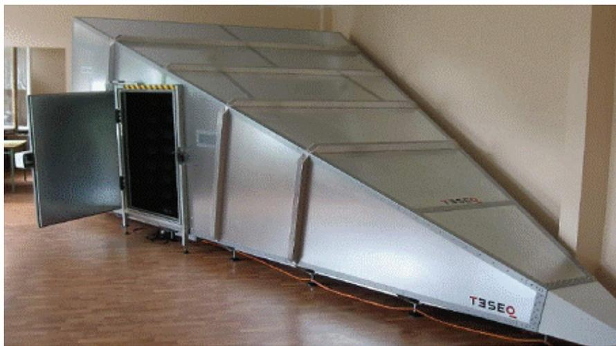
Рисунок 1 – ГТЕМ-камера фирмы TESEQ
