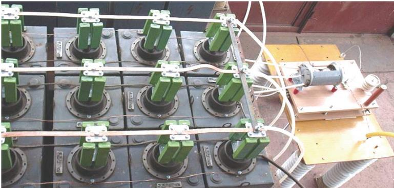
Рисунок 1 – Внешний вид фрагмента зарядно-разрядных цепей мощного ЕНЭ на 50 кВ и запасаемую электрическую энергию  $W_{ЕНЭ} = 420$  кДж с высоковольтными импульсными конденсаторами типа ИК-50-3 и жестко установленными на их высоковольтных выводах защитными керамическими резисторами типа ТВО-60-24 Ом [4]
