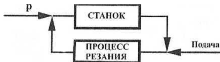
Рис. 1– Станок и процесс резания, как замкнутый контур
