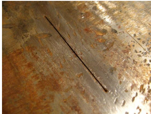
Рис. 1 – Внешний вид модели поверхностного дефекта изготовленного с помощью разработанной электроэрозионной установки
