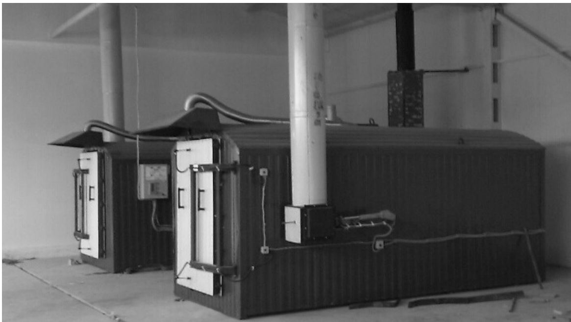
Рис. 3. Сучасна вуглевипалювальна піч виробництва ТОВ «GreenPower»
