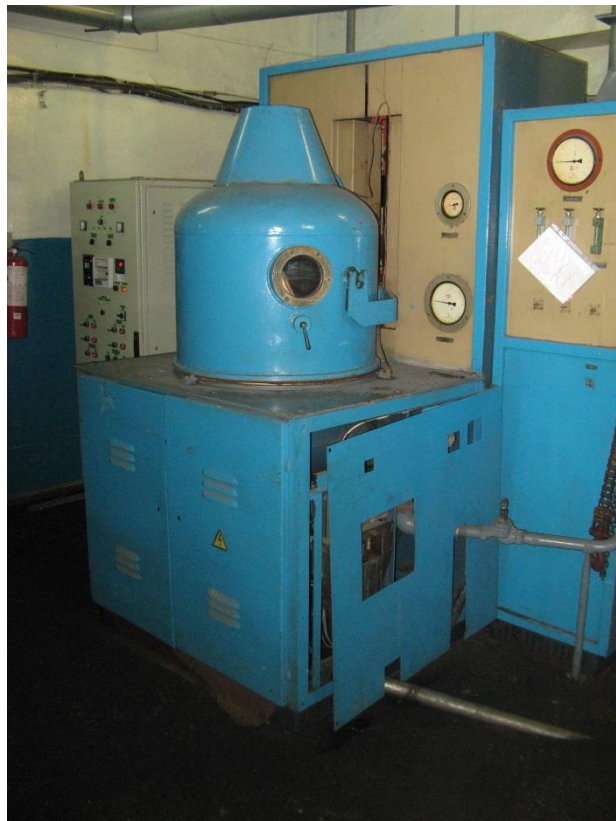
Рис. 5 – Загальний вид печі для іонно-плазмового азотування НГВ 6,6/6
