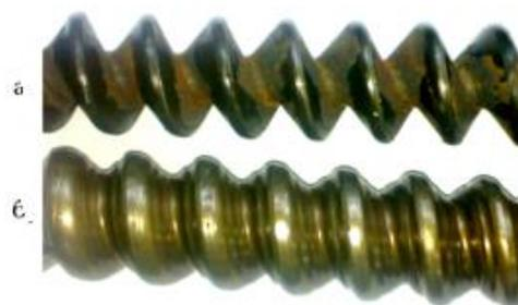
Рис. 2 – Фотографії: а – оправка; б – гвинтоподібна труба з зовнішнім діаметром 38×1 мм з кроком гвинта 20 мм
