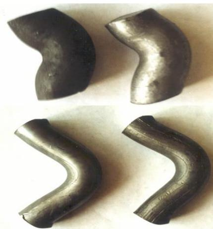
Рис. 1 – Заготовки после продольного изгиба
