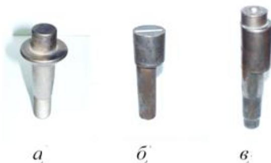
Рис. 1 – Детали типа: а – ступенчатый и б, в – эксцентриковый валы
