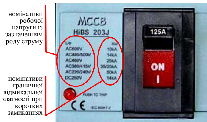
Рис. 4 – Лицьова панель апарата захисту від коротких замикань, на якій виробник розмістив номінативи граничної вимикальної здатності цього апарата при коротких замиканнях ( I_{cu} ) залежно від роду струму (AC / DC) та номінативу робочої напруги ( U_e )
