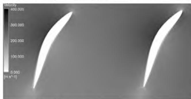
Рис. 2 – Фрагмент мгновенного поля скорости при обтекании решетки профилей для углов атаки  $i = -5^\circ$  и числа Maxa  $M = 0,729$
