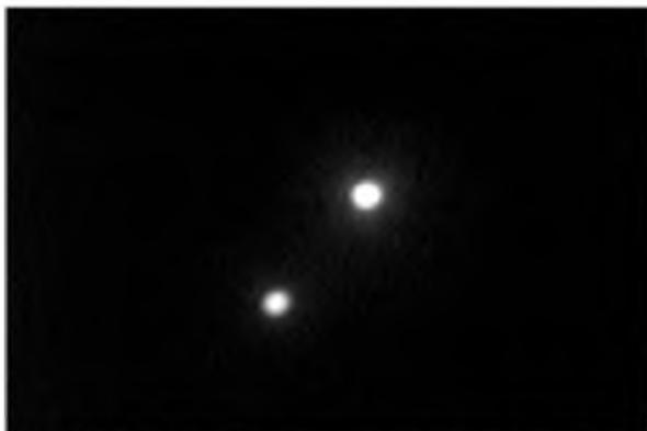
Рис. 5 – Електролюмінісцентні дефекти сонячного елементу на кристалічному кремнії, збільшення у 50 раз, відстань між дефектами 200 мкм
