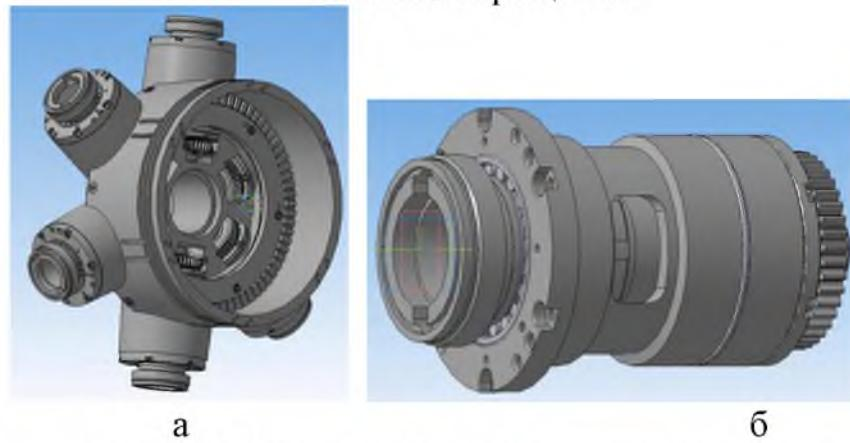
Рис. 3 – 3D-модели формообразующих узлов: а – шестишпиндельная револьверная головка; б – шпиндельный узел
