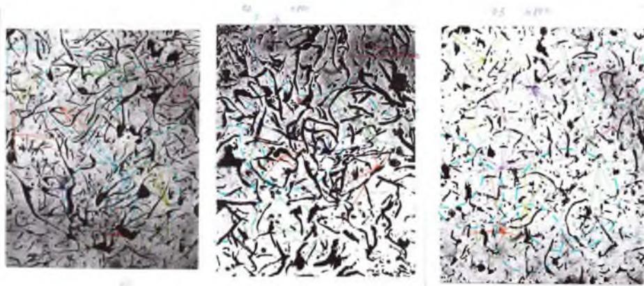
Рис. 1 – Мікроструктури чавуну, модифікованого феросиліцієм ФС75, x100 а – початковий момент модифікування, б – через 5 хв. після модифікування, в – через 10 хв. після модифікування
