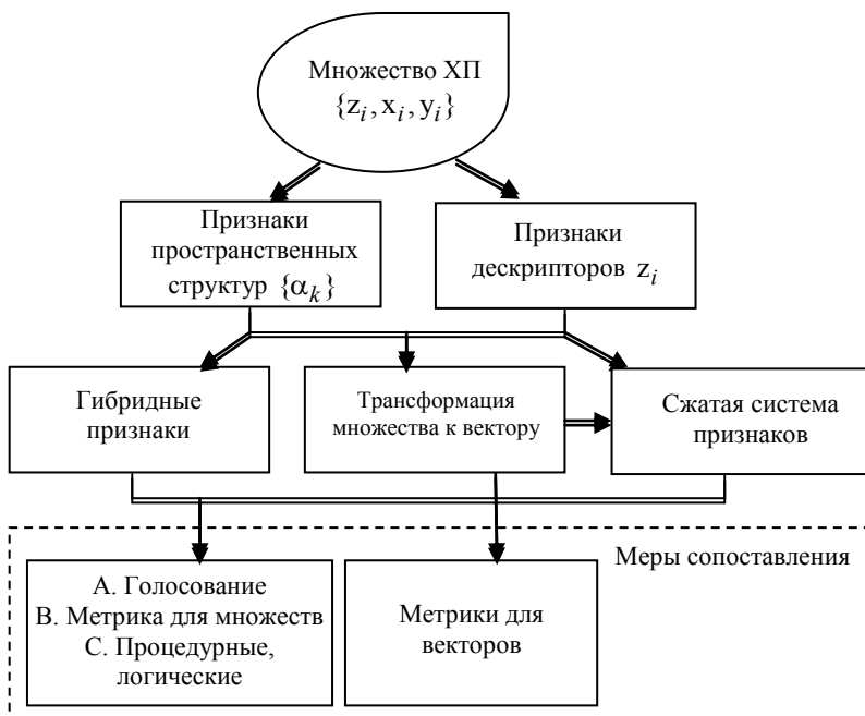
Рис. 2. Схема построения модификаций структурных описаний
