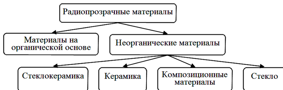
Рис. 2 – Классификация радиопрозрачных материалов
