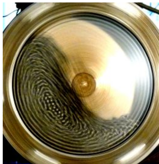
Рис. 5 – Розрахункова (а) та експериментальна (б) картини руху завантаження при \psi_{\omega} = 0,75 , \kappa = 0,35 , d/D = 0,026 та гладкій камері.
