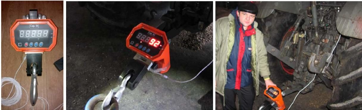
Рис. 5 – Електронний динамометр
