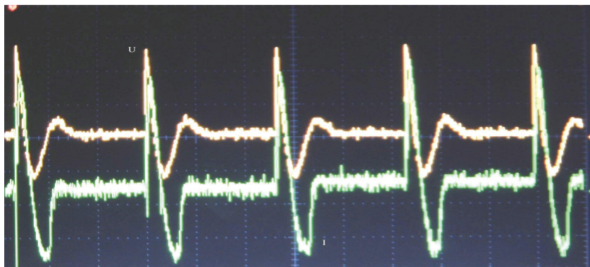
Рисунок 2 – Осциллограммы разрядного процесса импульсного источников питания, необходимого для деструкции двуокиси серы
