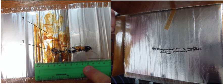
Рисунок 1 – Следы пробоев внутри секций (слева сквозной – поз. 1, справа – ниточный, следы побежалости – поз. 2)
