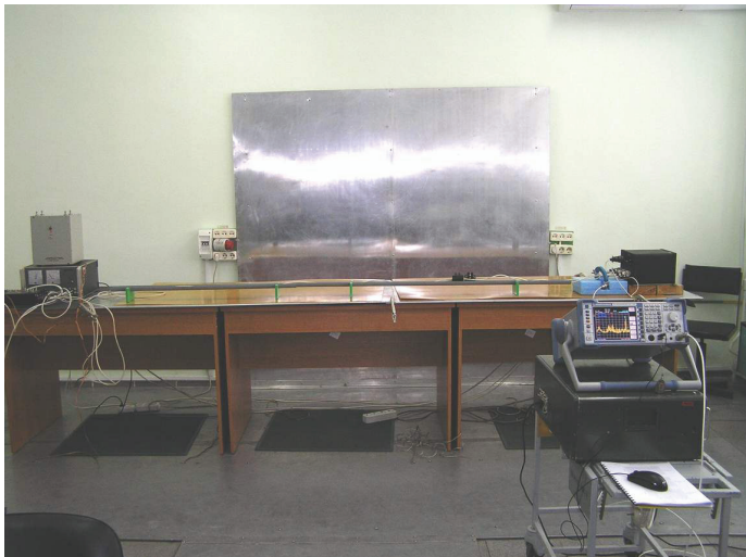
Рисунок 13 – Рабочее место при измерении эмиссии тока радиопомех
