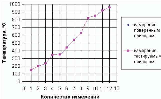
Рисунок 6 – Графики измерения значения температуры: поверенным прибором и тестируемым прибором.
