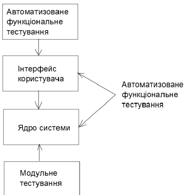
Рис. 2 – Одночасне використання автоматизованого тестування за сценаріями користувача та модульного тестування
