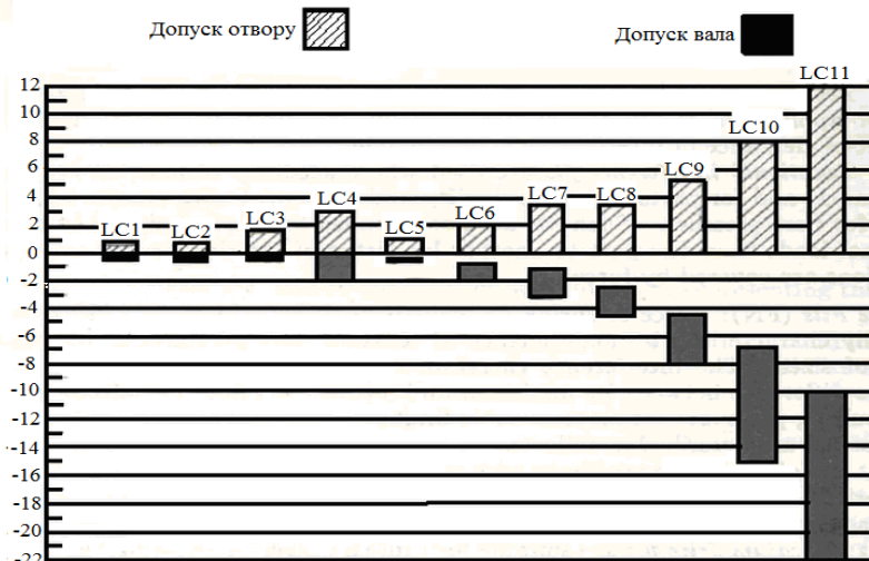
Рис. 5 – Графічне подання розташування перехідних посадок із зазором
