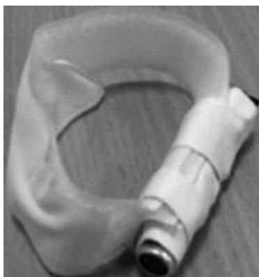
Рис.11. - Ультразвуковой излучатель, размещается на внешней стороне кисти метателя.
