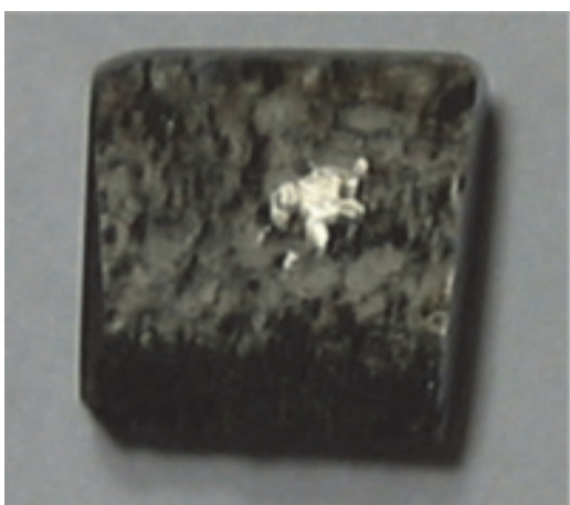
Рис. 6 – Экспериментальный образец из лопаточного материала с противоэрозионным защитным покрытием, нанесенным методом электроискрового упрочнения
