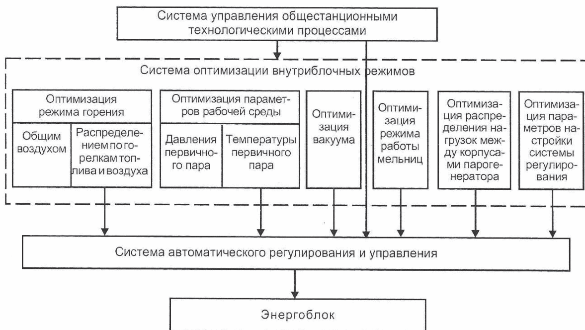
Рис. 2 – Структурная схема системы управления энергоблоком
