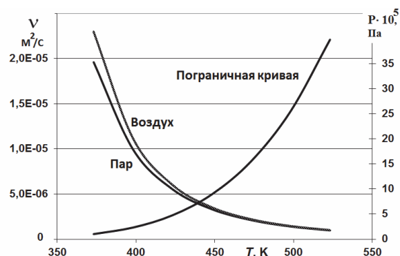
Рис. 2 – Плотность водяного пара и воздуха для давления и температуры вдоль кривой насыщения
