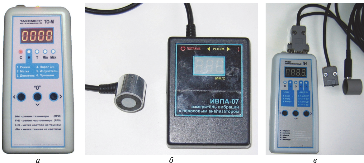
Рис. 4 – Мобільні пристрої: а – тахометр; б – віброметр із полосовим спектроаналізатором; в – пристрій визначення місця дисбалансу жорстких роторів
