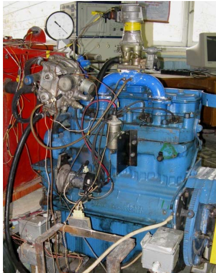
Рисунок 1 – Переобладнаний з дизеля Д-240 газовий двигун на випробувальному стенді
