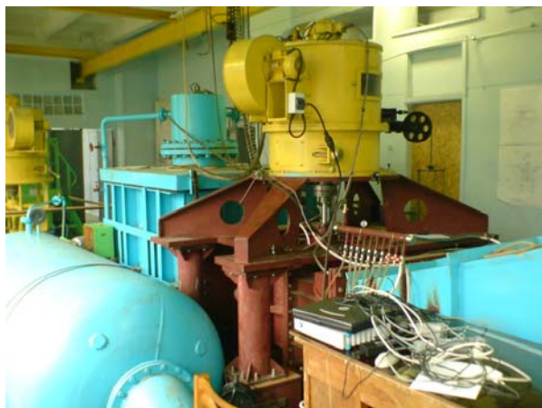
Рис. 5 – Модельный блок, установленный на энергокавитационном стенде ЭКС-15
