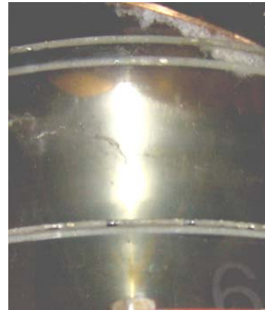
Рис. 9 – Фотография течения в рабочем колесе модели поворотнo-лопастной гидротурбины ПЛ30-В-35
