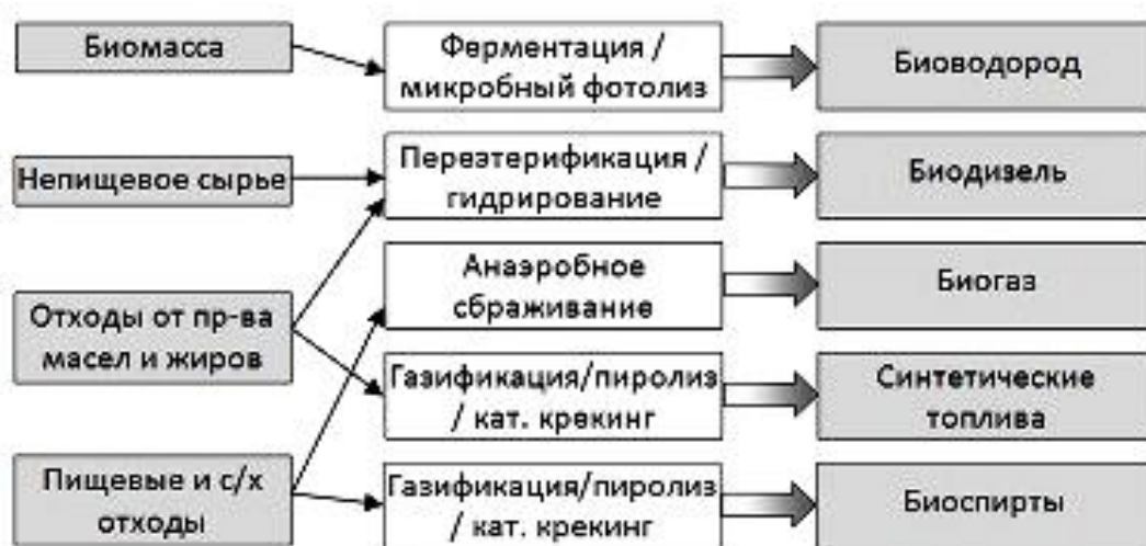
Рис. 1 – Функциональная схема образования биотоплива второго поколения
