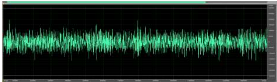
Рис. 1 – Вигляд сигналу, що надходить на вхід мікроконтролерної системи діагностування
