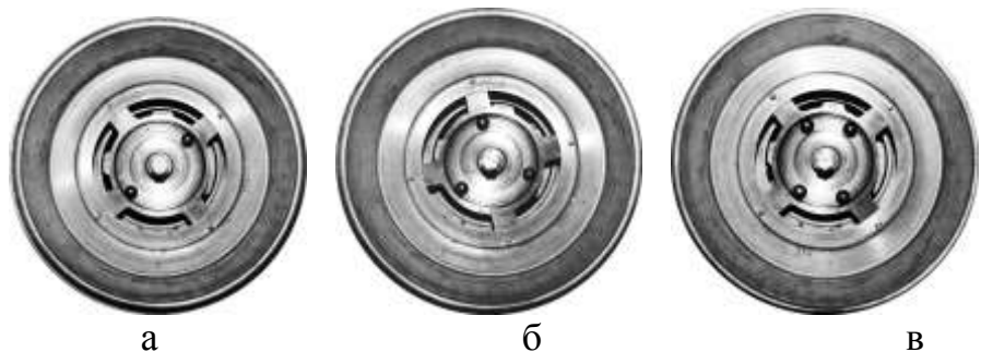
Рис. 4 – Автобалансирующие положения шаров при отсутствии дисбаланса и разном количестве шаров в АБ: а – два шара; б – три шара; в – четыре шара
