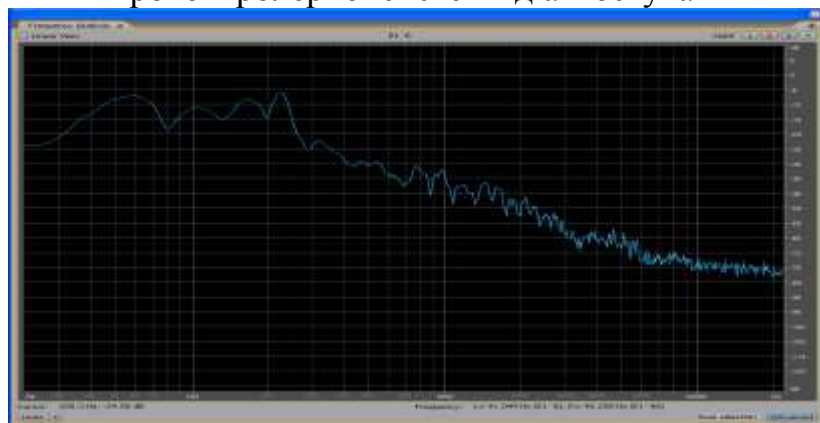
Рис. 3 – Детальний спектр вхідного сигналу в логарифмічному масштабі
